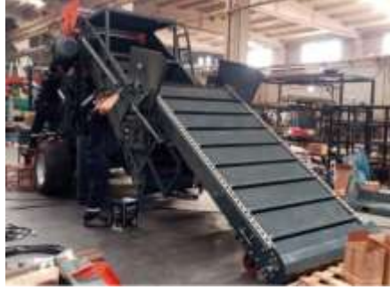
Şekil 9. Yükleme bandı ve yükleme bunkeri
