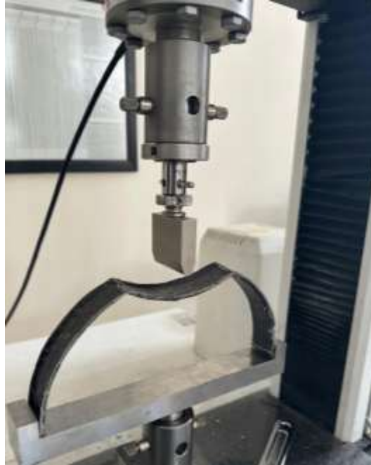
Şekil 3. Ön İniş Takımı Basma Testi
