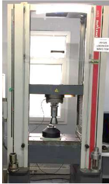
Şekil 2. Statik Basma Testleri için kullanılan Statik Test Cihazı
