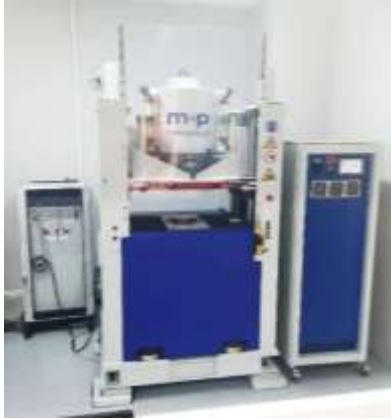
Şekil 3. (a) M+P International Yüksek Frekans Dinamik Test Cihazı (b) Kauçuk Takoz Test Numunesi
