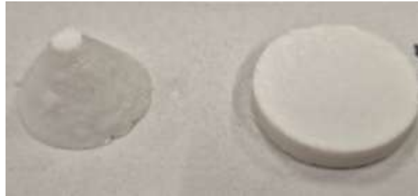
Görsel 3. Adıyaman Feldspat Numunesine Ait Pişme Görselidir.
