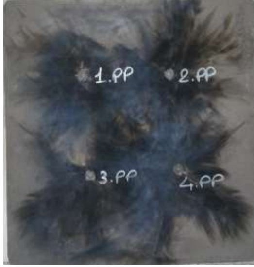
Şekil 6. Balistik Test Sonrası 500 HB Malzeme
