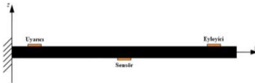
Şekil 1. Piezoelektrik yamaların yerleşimi.
