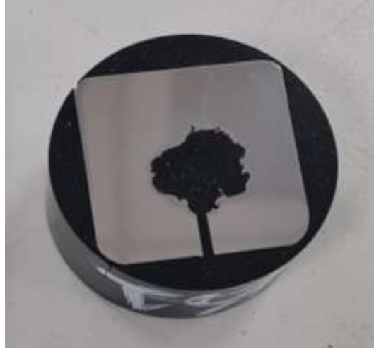
Şekil 7. Balistik test sonrası bakalite alınmış 500 HB numune
