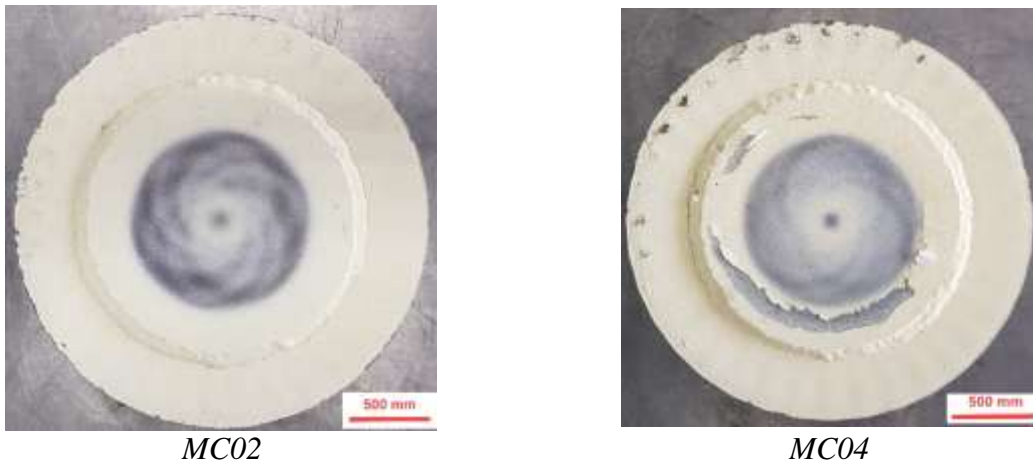
Şekil. 10. Numunelerin 30 Çevrim Sonrası Görünümleri
