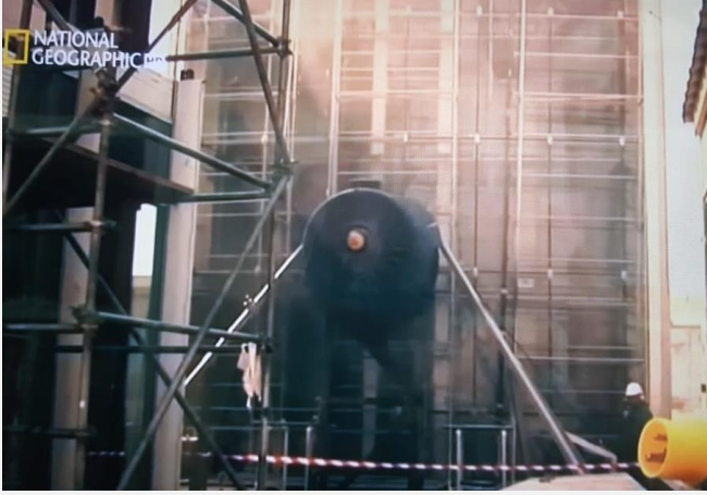
Resim 32: Uçak Motoru İle Camların Denenmesi
