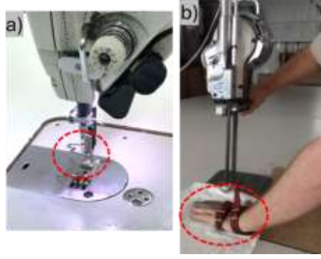
Şek 5. Makine koruyucu donanım örnekleri a) Dikiş makinesi parmak koruyucu aparatı, b) Kesim motoru için üç parmak çelik eldiven.
