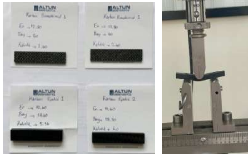
Şekil 5. Eğilme test numuneleri ve üç nokta eğilme test anı.
