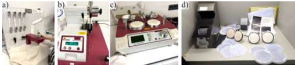
Şek 1. Uygulanan testler: a) Hava geçirgenliği b) Yırtılma mukavemeti c) Boncuklanma direnci d) Değerlendirme kabini
