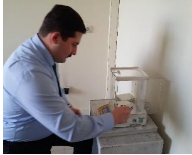
Şekil 3.2 Toz numune filtrelerinin hassas terazide kütlelerinin ölçülmesi
