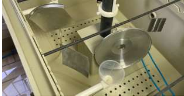
Şekil 6: Numune parçaların test cihazına bağlanması
