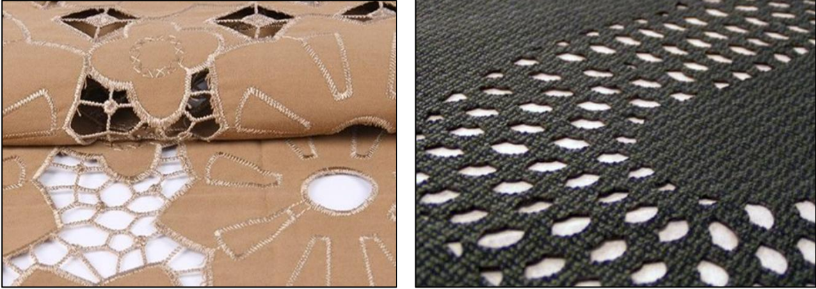
Şekil 13. Lazer kesmeli (a) ve lazer yakmalı (b) kumaş (görseller çeşitli kaynaklardan derlenerek yazarlar tarafından oluşturulmuştur)
