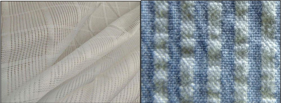
Şekil 2. Farklı sıklık (a) ve farklı çözgü gerilimi (b) uygulanmış kumaş (görseller çeşitli kaynaklardan derlenerek yazarlar tarafından oluşturulmuştur)
