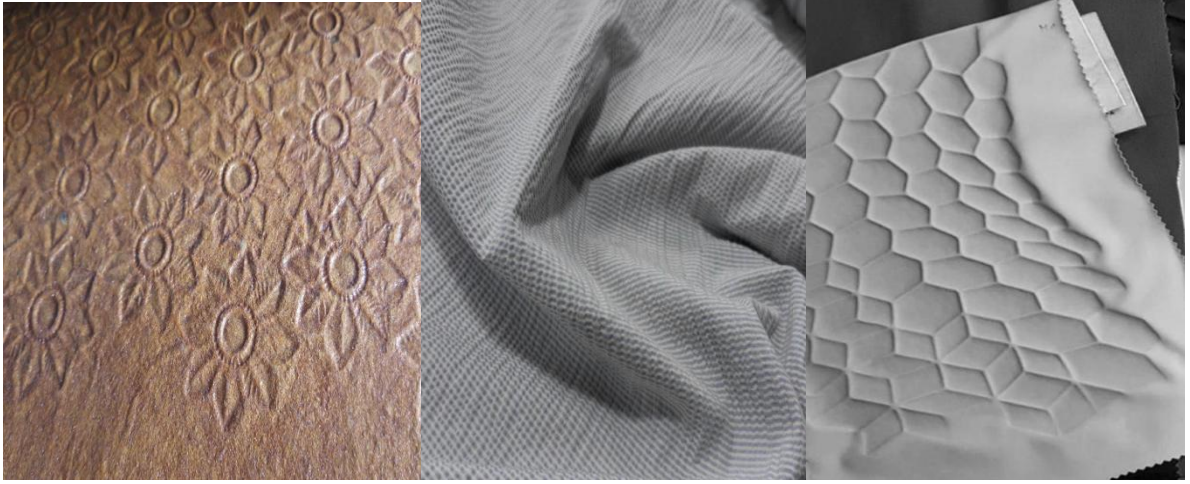
Şekil 14. Kabartma (a), gofre (b) ve 3D uygulamaları yapılmış kumaşlar (görseller çeşitli kaynaklardan derlenerek yazarlar tarafından oluşturulmuştur)
