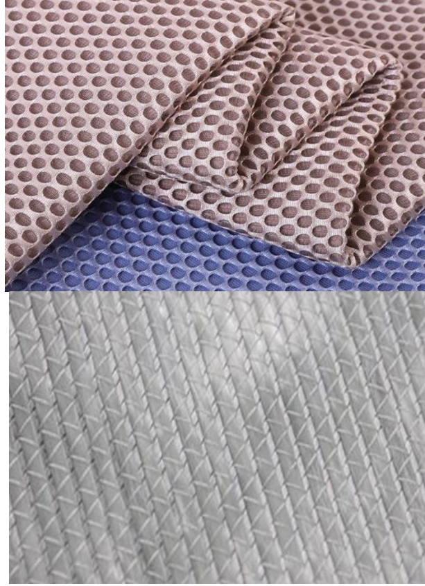
Şekil 15. 3D dokuma (a) ve çok eksenli dokuma (b) kumaş (görseller çeşitli kaynaklardan derlenerek yazarlar tarafından oluşturulmuştur)
