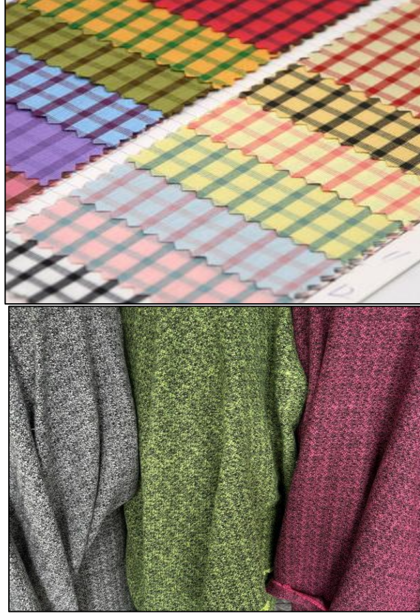
Şekil 7. İpliği boyalı (a) ve elyaf boyalı harman karışımı melanj kumaş (b) (görseller çeşitli kaynaklardan derlenerek yazarlar tarafından oluşturulmuştur)
