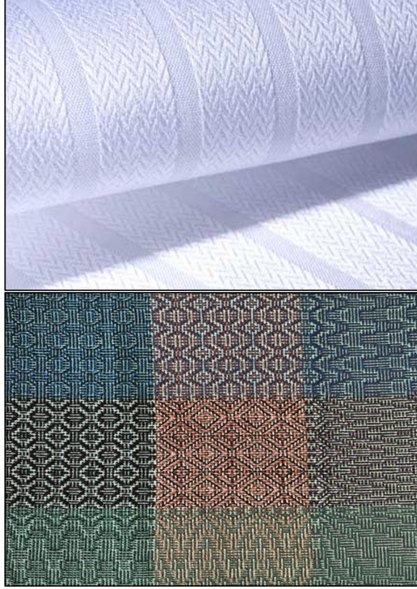
Şekil 1. Farklı örgü yapılarının birarada kullanıldığı gömleklik (a) ve pike kumaşı (b) (görseller çeşitli kaynaklardan derlenerek yazarlar tarafından oluşturulmuştur)
