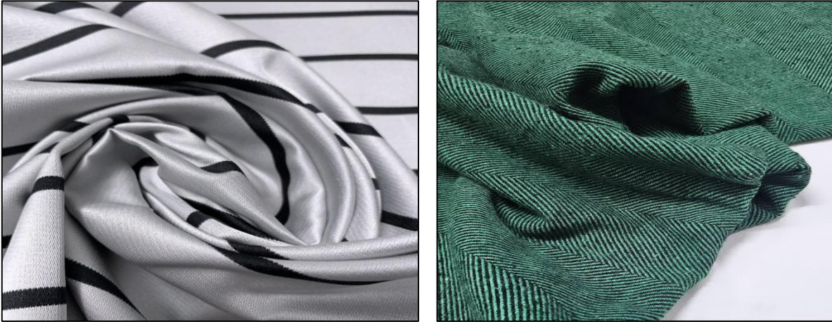
Şekil 10. Kalandır ile parlak yüzeyli kumaş (a) ve liza ile hacimlendirilmiş kumaş (b) (görseller çeşitli kaynaklardan derlenerek yazarlar tarafından oluşturulmuştur)
