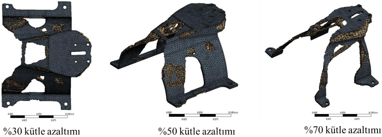
Şekil 5. TO sonucu elde edilen braket yapıları
