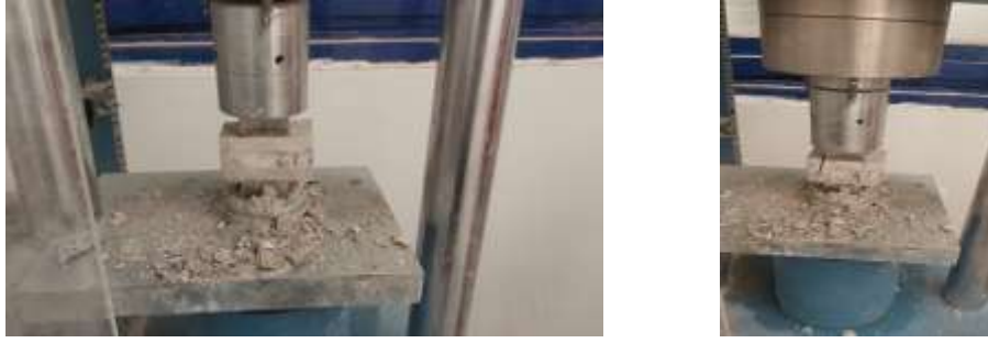
Şekil 6, 7. Basınç Dayanım Deneyi
