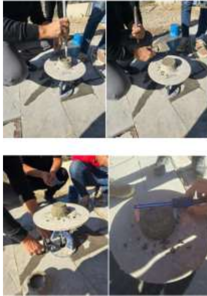
Şekil 2. Yayılma Tablası Deneyi
