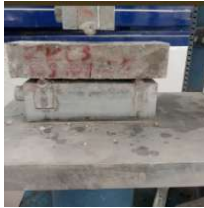
Şekil 4, 5. Eğilme Dayanımı Deneyi
