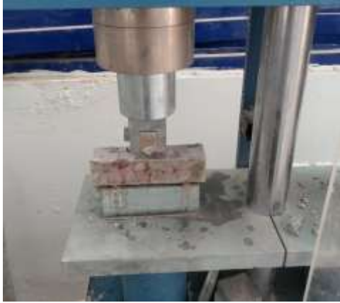
Şekil 4, 5. Eğilme Dayanımı Deneyi
