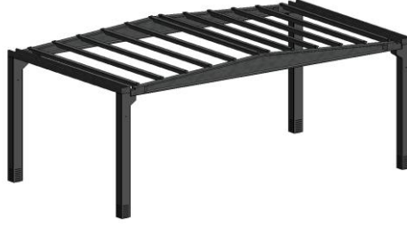
Şekil 1. Oluşturulan tek açıklıklı örnek prefabrik üstyapı tasarımı
