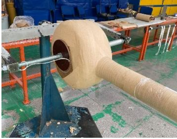
Resim 7. İzole edilmiş primer bobin Bobinler nüveye geçirildi ve Resim 8’de görüldüğü üzere sabitlemesi yapıldı.
