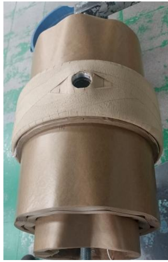
Resim 5. Ekranlama silindiri geçirilmiş sargı
