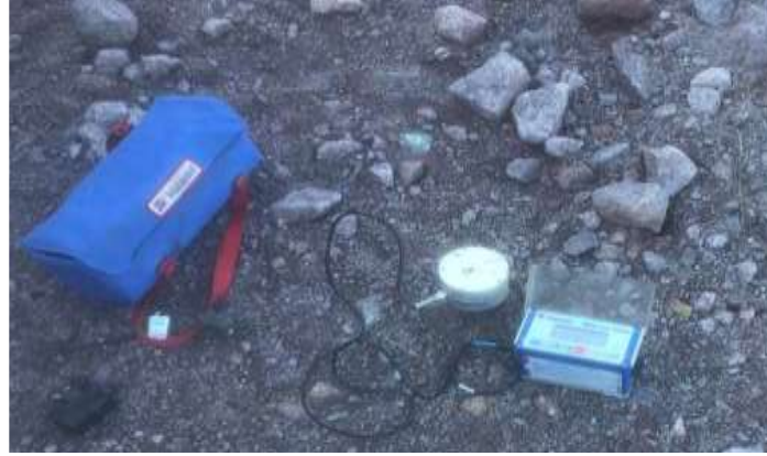
Şekil 4. Sahada sismograf ile yapılan titreşim ölçümü
