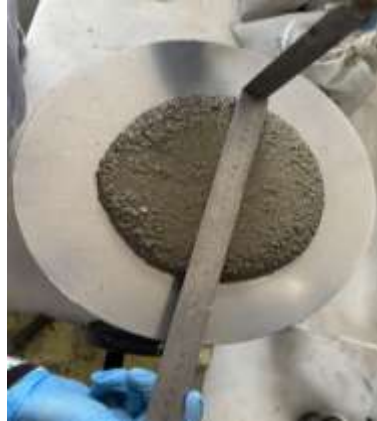
Şekil 1. 0,6 KL karışımının yayılma ölçümü
