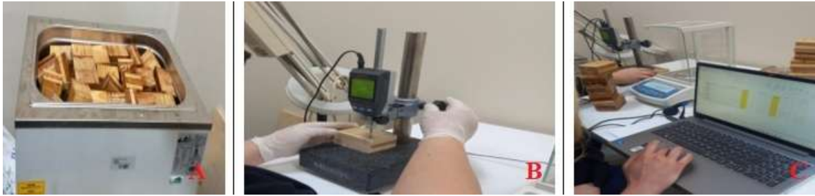
Şekil 4: Numune ölçümlerinin aşamaları A: Su banyosu, B: Numunelerin kondansatör ile ölçümleri, C: Verilerin sisteme aktarılması.
