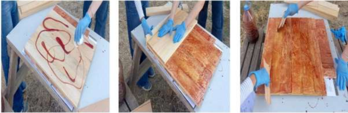
Şekil 2: Tutkallama ve tabaka oluşturma aşamaları
