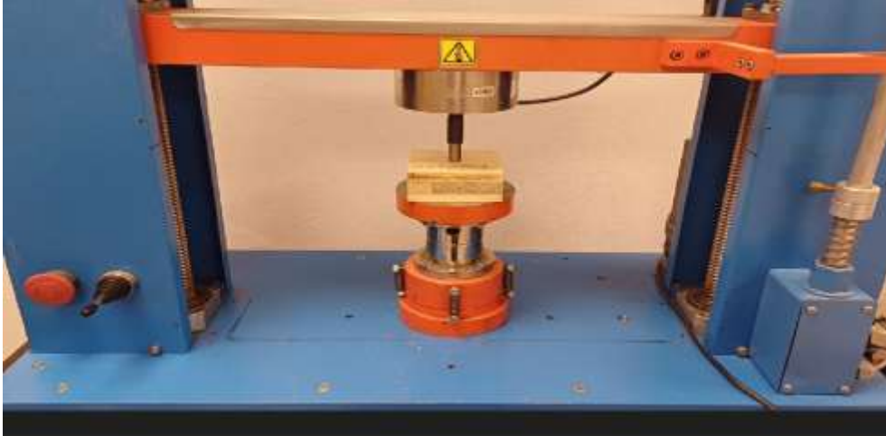
Şekil 4 : Statik sertlik tayini belirlenmesinde kullanılan deney numunelerinin görüntüsü ve deneyin yapılışı
