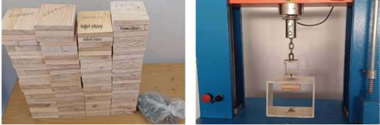
Şekil 6: Vida tutma kapasitesinin belirlenmesinde kullanılan deney numunelerinin görüntüsü ve deneyin yapılışı.
