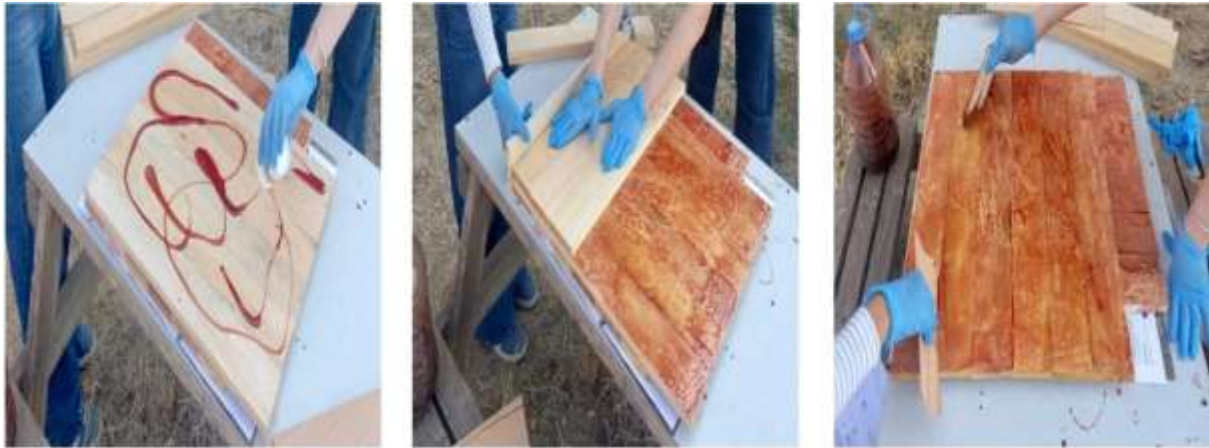
Şekil 2: Tutkallama ve tabaka oluşturma aşamaları
