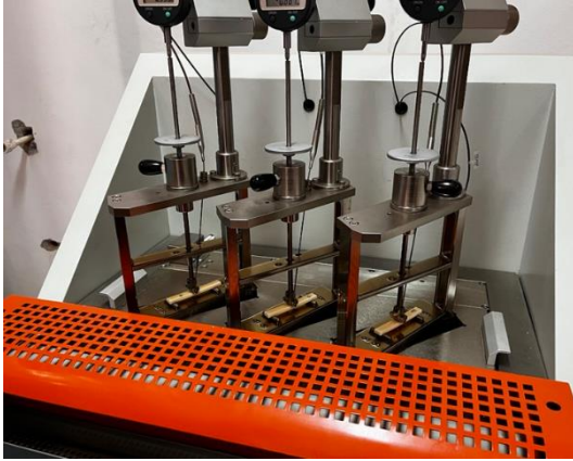
Şekil 8. HDT termal eğilme test sonrası bazı numunelerin görselleri
