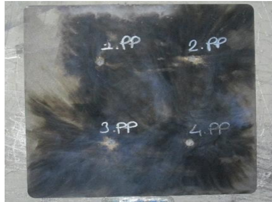
Şekil 3. Balistik Test Sonrası 600 HB Malzeme
