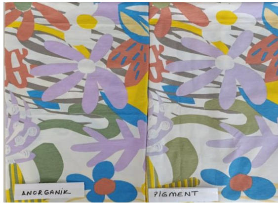
Şekil 1: Anorganik doğal boyalar ve sentetik pigment boyalar kullanılarak işletme koşullarında yapılan baskı işlemlerine ait numuneler
