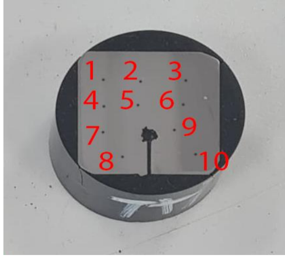
Şekil 2. Bakalite alınan 600 HB malzeme
