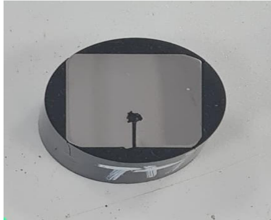
Şekil 2. Bakalite alınan 600 HB malzeme
