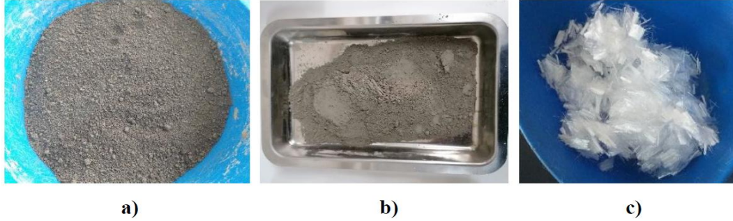
Şekil 1. Çalışmada kullanılan malzemeler a) doğal kil, b) Portland çimentosu, c) polipropilen elyaf
