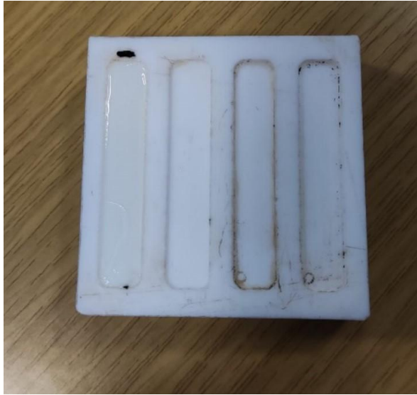
Şekil 2.7. Sentezlenen maddenin üretan diakrilat beraberinde döküldüğü kalıplar
